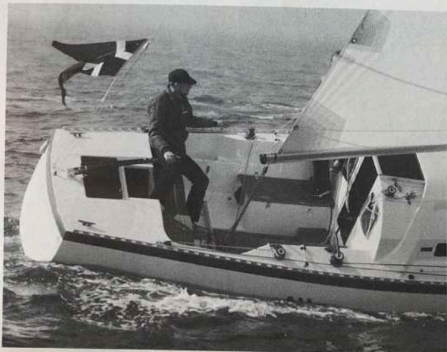
Solus Alta's cockpit er efter klassisk recept, og der er sørget for de tilbageførte hal.
