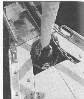
Rullebeslaget til genuaen er anbragt nede i ankerbrønden på Vitesse 33. På afstand kan den ikke ses under sejls. Stævnbeslaget er solidt.
